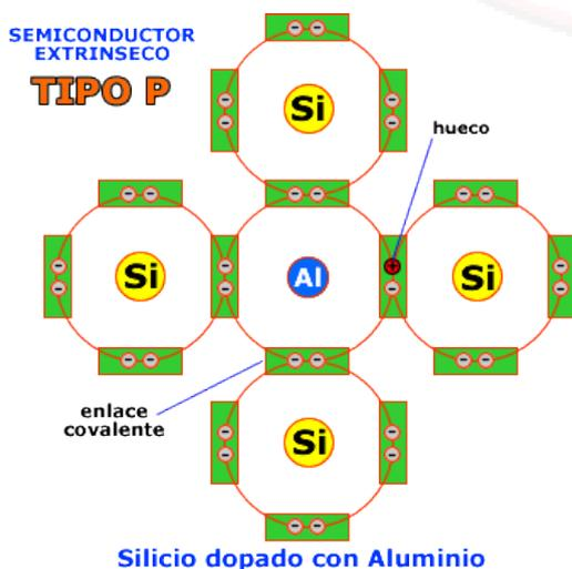
En la figura se presenta la estructura cristalina del Silicio (Si) dopado con Aluminio (Al). Por cada átomo de impurezas trivalente que se añade al semiconductor intrínseco aparece en la estructura un hueco, o lo que es lo mismo, la falta de un electrón.
