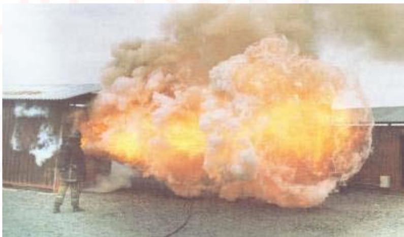
Para que se produzca una explosión BLEVE no es necesaria la existencia de reacciones químicas ni fenómenos de combustión. Podría producirse incluso en calentadores de agua y calderas de vapor. En principio podría originarse en cualquier líquido almacenado en un recipiente hermético, aunque hay explosiones que pueden confundirse con una BLEVE sin serlo. Las BLEVES son exclusivas de los líquidos o gases licuados en determinadas condiciones.
