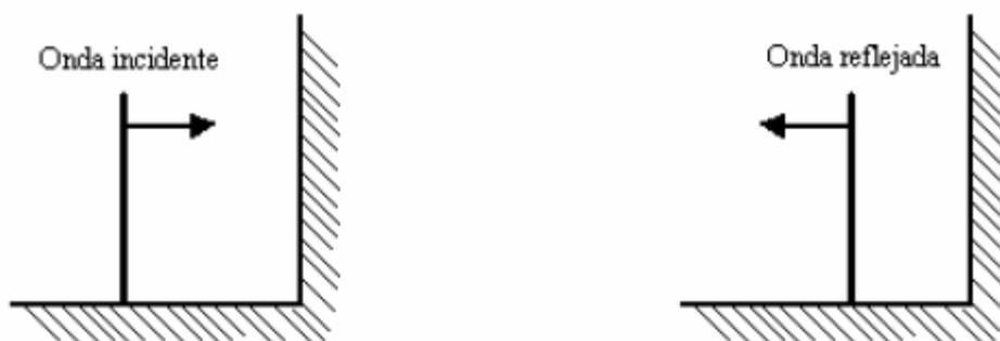
FIGURA Reflexión de una onda de presión en el choque perpendicular contra un obstáculo (Stull, D.R., 1976).
