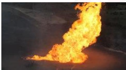
de presión significativas. Suele estar asociada a la dispersión de vapores inflamables a ras de suelo. Cuando éstos encuentran un punto de ignición, el frente de la llama generado se propaga hasta el punto de emisión, barriando y quemando toda la zona ocupada por los vapores en condiciones de inflamabilidad. Si el origen de los vapores es un vertido con evaporación, el fenómeno acaba en
