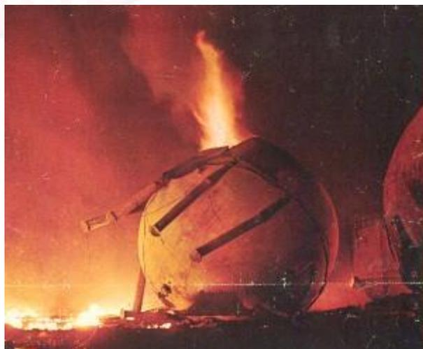
situaciones de presión y temperatura, el recipiente que las contiene se rompe repentinamente y si está asociado al fenómeno de bola de fuego, el alcance de la magnitud física peligrosa, que caracteriza el efecto mecánico (sobrepresión), suele ser inferior al alcance de la radiación; de ahí que la planificación de emergencias sólo se realice teniendo en cuenta los daños de este último fenómeno.
