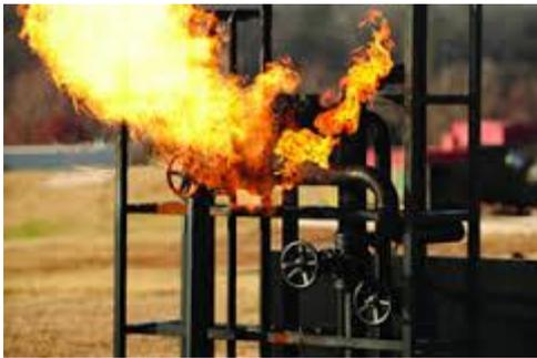
Los efectos de este tipo de accidentes son fundamentalmente los causados en el entorno por el calor generado e irradiado desde el dardo.
