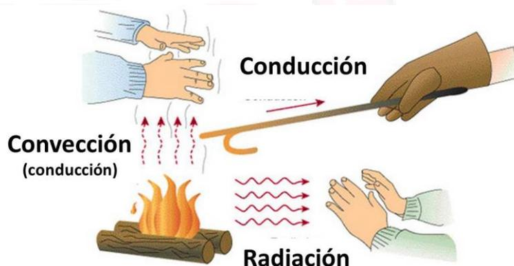
Cuando existe una diferencia de temperatura entre dos objetos en proximidad uno del otro, la transferencia de calor no puede ser detenida; solo puede hacerse más lenta.
